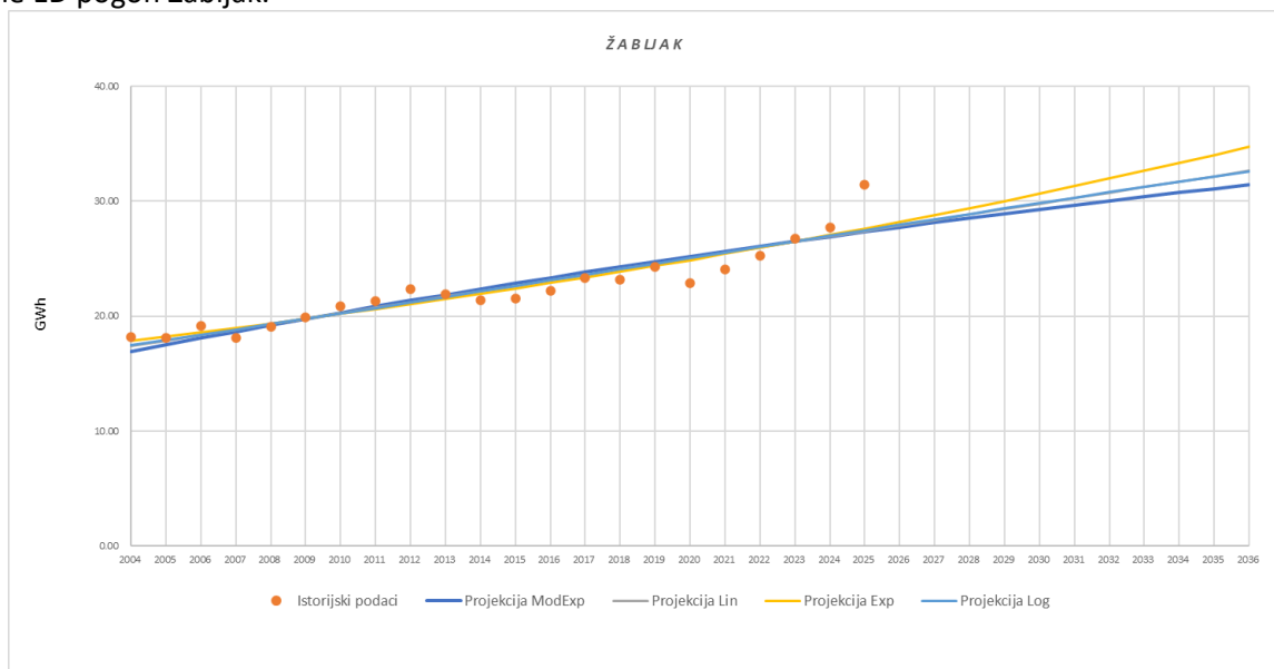
Slika 6-43. Grafički prikaz rezultata prognoznih modela za ED pogon Žabljak
